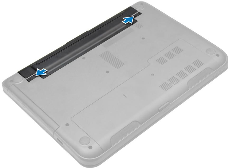
3. Heben Sie den Akku an, um ihn aus dem Computer zu entfernen.
