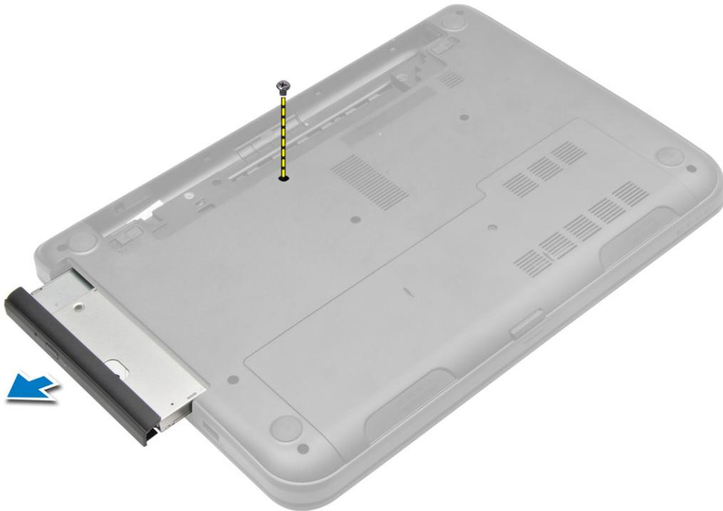
4. Entfernen Sie die Schraube, mit der die Halterung des optischen Laufwerks am optischen Laufwerk befestigt ist, und entfernen Sie sie.
