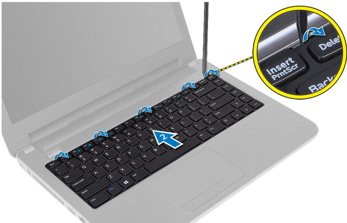
5. Entfernen Sie das Tastaturkabel von der Systemplatine und heben Sie die Karte nach oben, um sie vom Computer zu entfernen.
