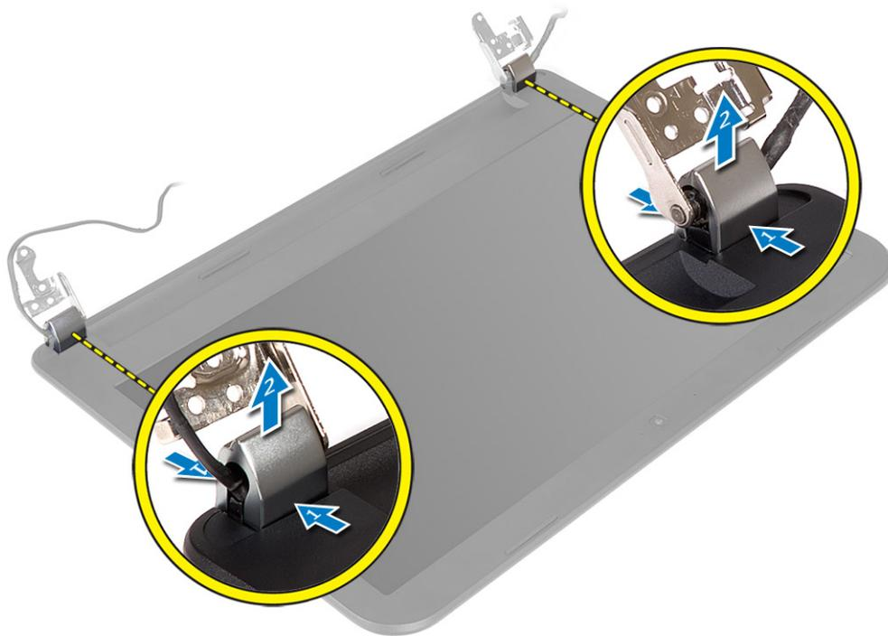
4. Hebeln Sie die Kanten der Bildschirmblende nach oben. Entfernen Sie die Bildschirmblende vom Computer.
