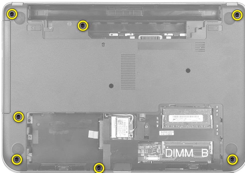
4. Drehen Sie den Computer um und entfernen Sie die Schrauben, mit denen die Handballenstütze an der Systemplatine befestigt ist.
