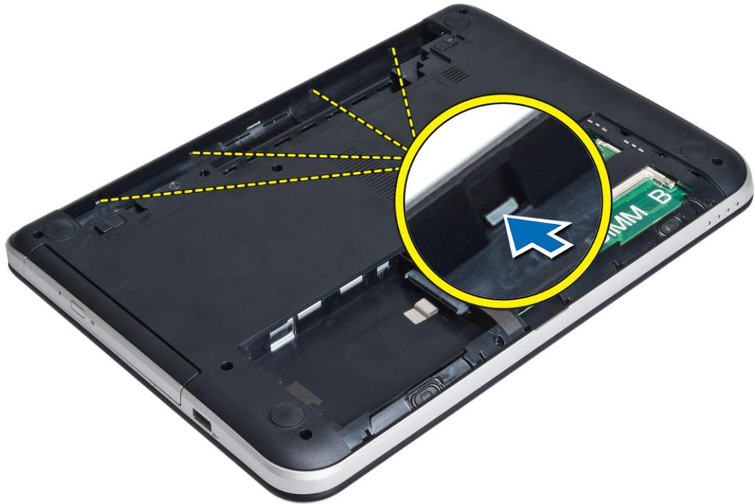
7. Drehen Sie den Computer um und lösen Sie die Halterungen an den Seiten, um die Handballenstütze vom Computer abzuheben.
