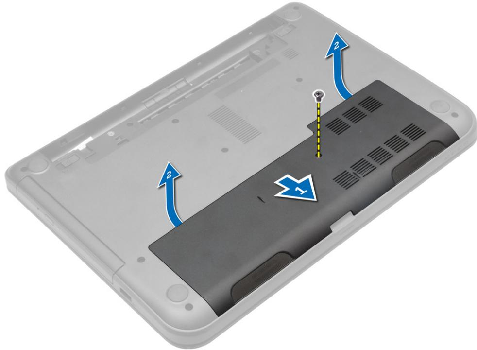
4. Heben Sie die Abdeckung an, um sie vom Computer zu entfernen.
