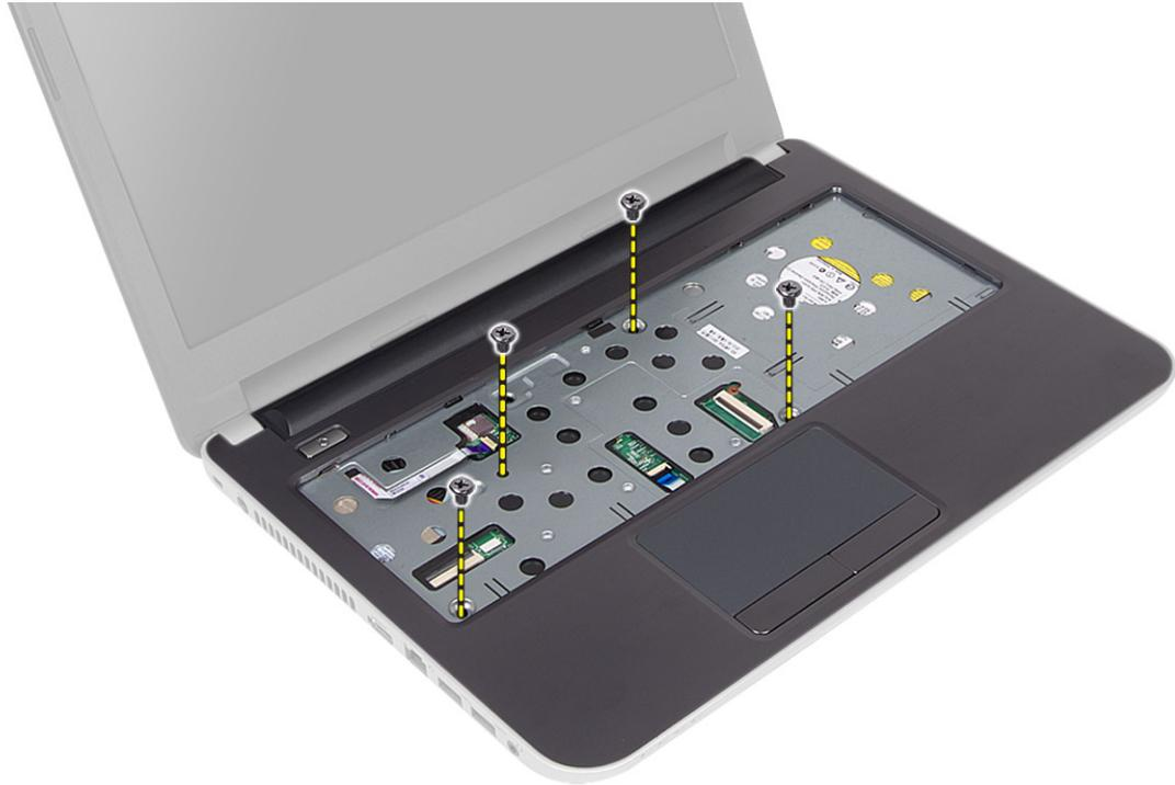
5. Trennen Sie die Touchpad- und Betriebsschalterkabel von der Hauptplatine.
